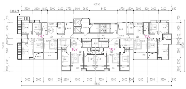
高层住宅楼标准层平面图 0 1 2 3 4 5M *本层建筑面积: 511.86平方米*
